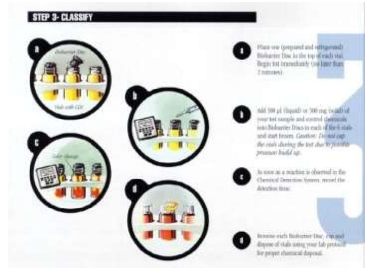
Determinación del tiempo que requieren para que un material de prueba pase por una membrana de colágeno reconstituida, de tal manera que produzca un cambio visual
