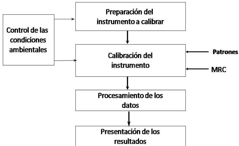
Figura 12. Diagrama en bloques del procedimiento general de calibración[37].
