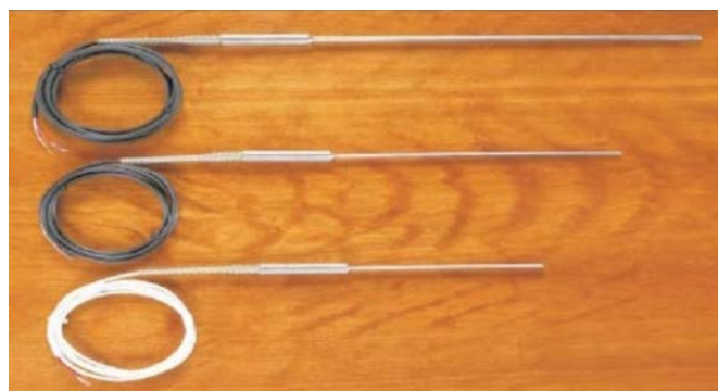
Figura 28. Sonda RTD utilizada para la calibración del termómetro[58].
