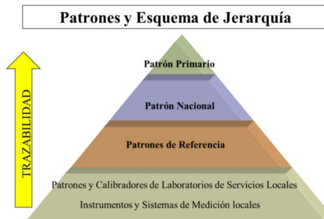
Figura 13. Cadena de trazabilidad de la calibración[36].
