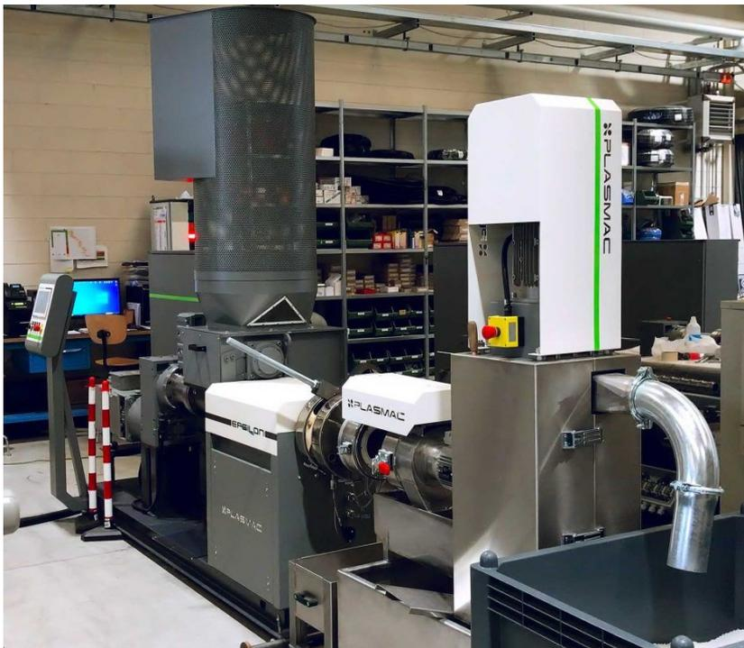
Para recortes gruesos de líneas de film soplado MDO de alta velocidad, con tecnología de tornillo de doble diámetro.
