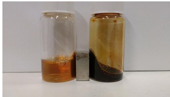
Los imanes cambian la presión hidrostática en el fluido y, la densidad aparente del fluido es cambia a diferentes alturas en el fluido.
