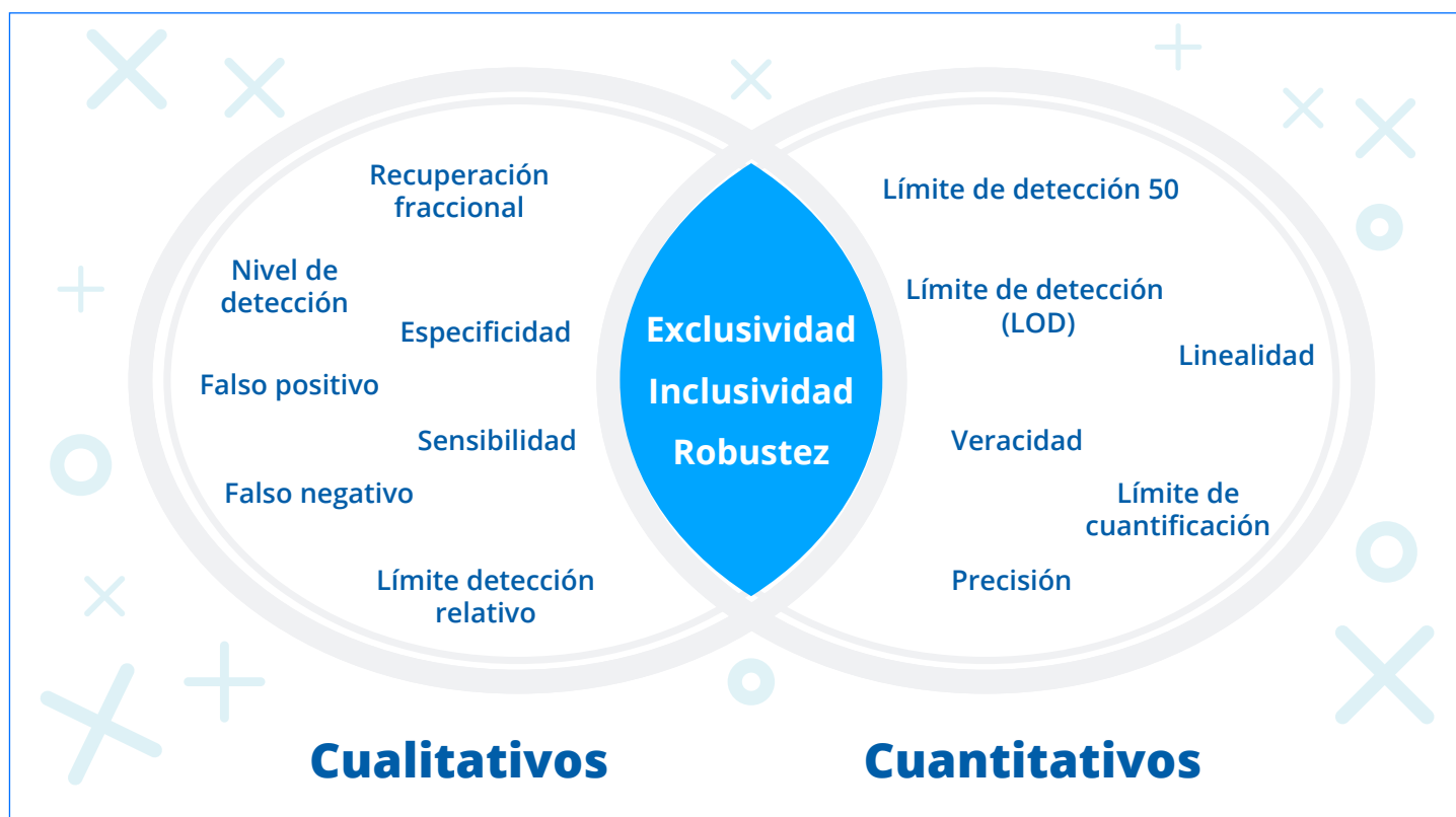
■ Figura 3: ISO 16140. Diagrama para la selección del protocolo de evaluación del desempeño a realizar.
